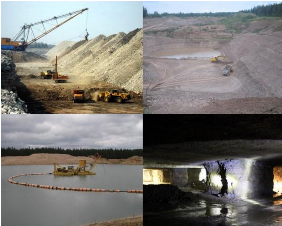
Joonis 4-2 Kaevandamisviisid (vaalkaevandamine, aukkaevandamine, veelune kaevandamine, kamberkaevandamine)
