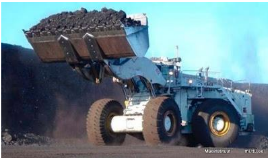
Joonis 4-4 Pealmaakopplaadur karjääris kivisütt kallurile laadimas
