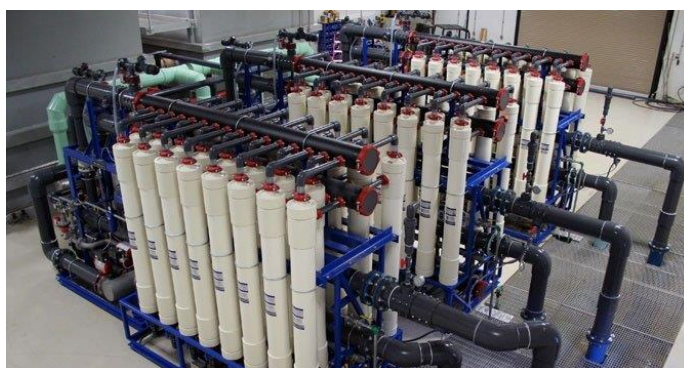
Joonis 1.4 Ultrafiltratsiooniseade (Ultrafiltration Membrane Systems)
