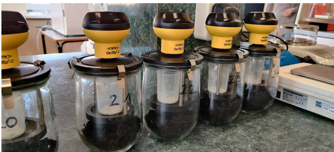
Joonis 3.4 Substraatide basaalse hingamisaktiivsuse mõõtmine WTW OxiTop-C manomeetriliste seadmetega.
