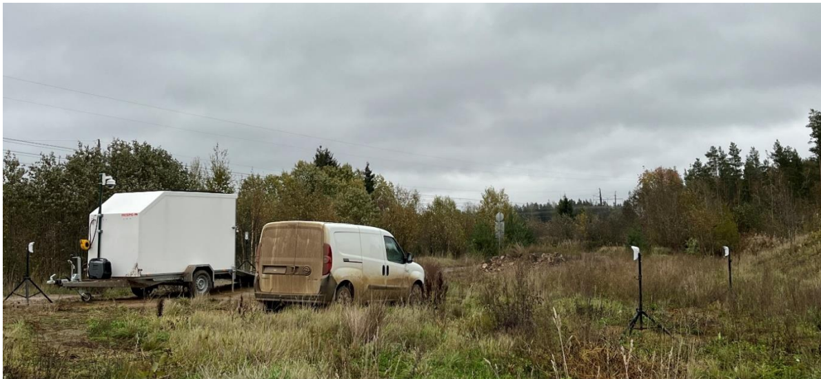
Joonis 20. Nelinurkselt paigaldatud liikumisandurid valvestatud ala tekitamiseks Hurtja liivakarjääris.
