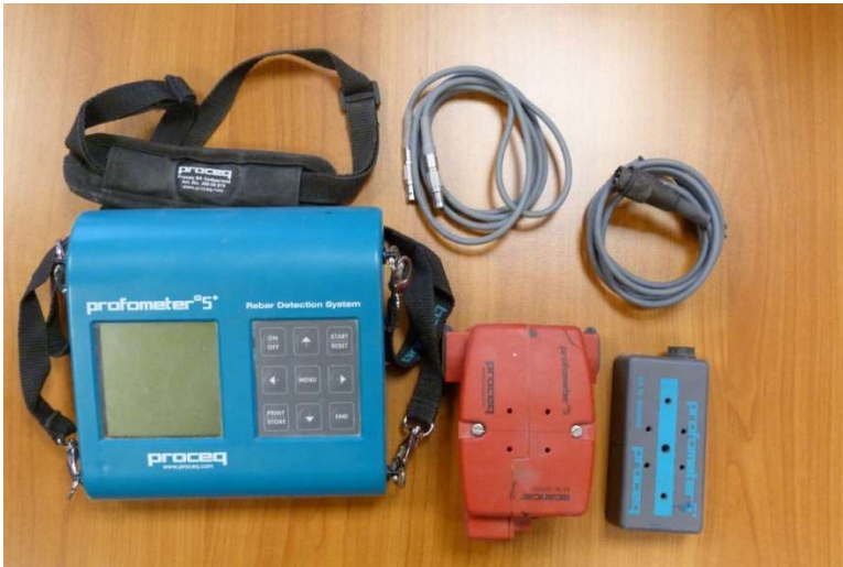
Foto nr. 4. Komplekse detektorsüsteemi Proceq Profometer 5+ komplekt.
