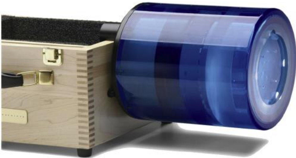
Joonis 7. Catphan 600 fantoom tootjalt The Phantom Laboratory [11].
