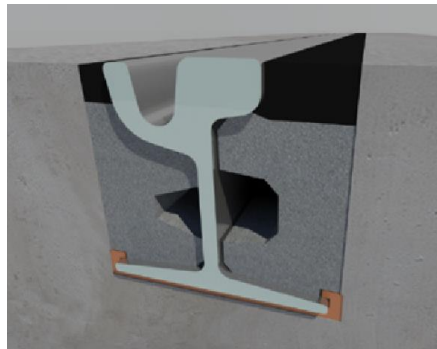
Joonis 5.4 Pideva toetusega konstruktsioon SDS (Sound Damping System) [49]
