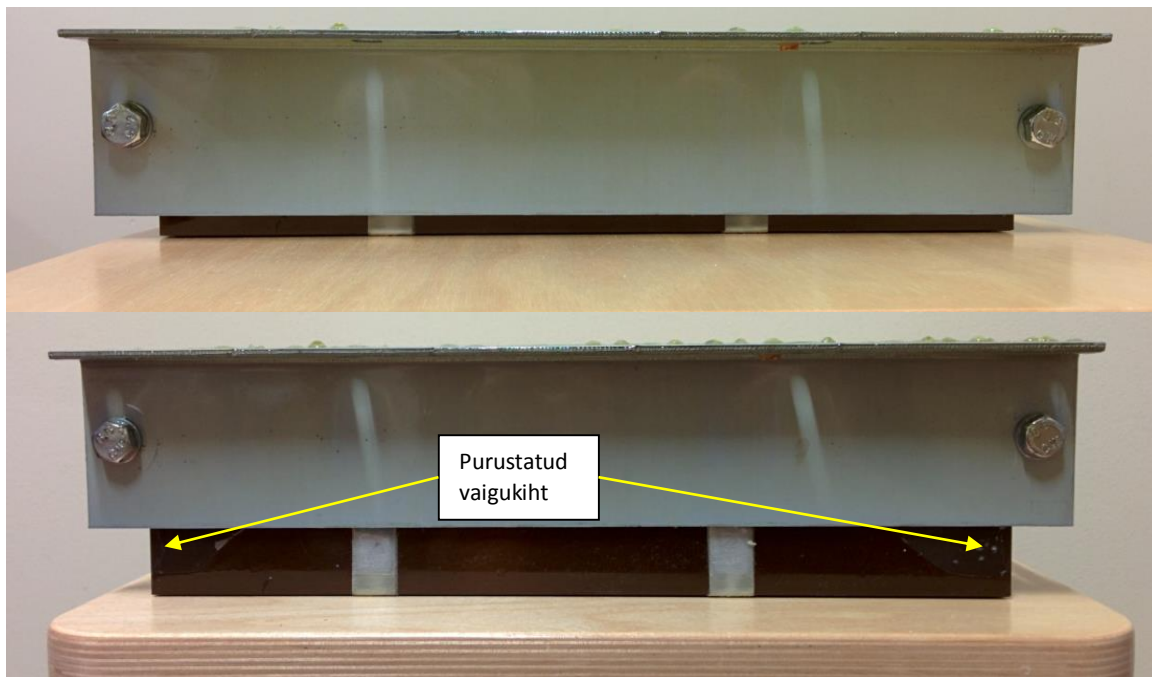
Sele 4.7. Vaigu ainega immutatud mudel enne ja pärast katset
