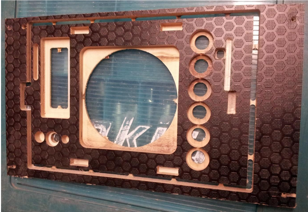
Joonis 28. Esipaneel seestpoolt vaadatuna
