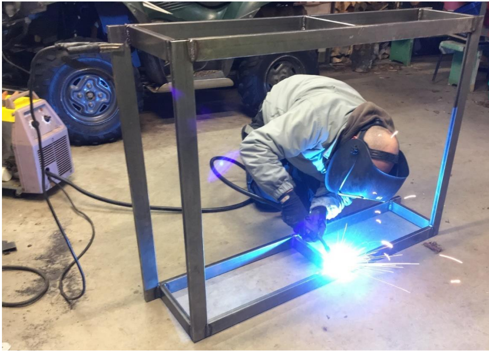
Joonis L1. MIG keevitusega alusraami kokkupanek
