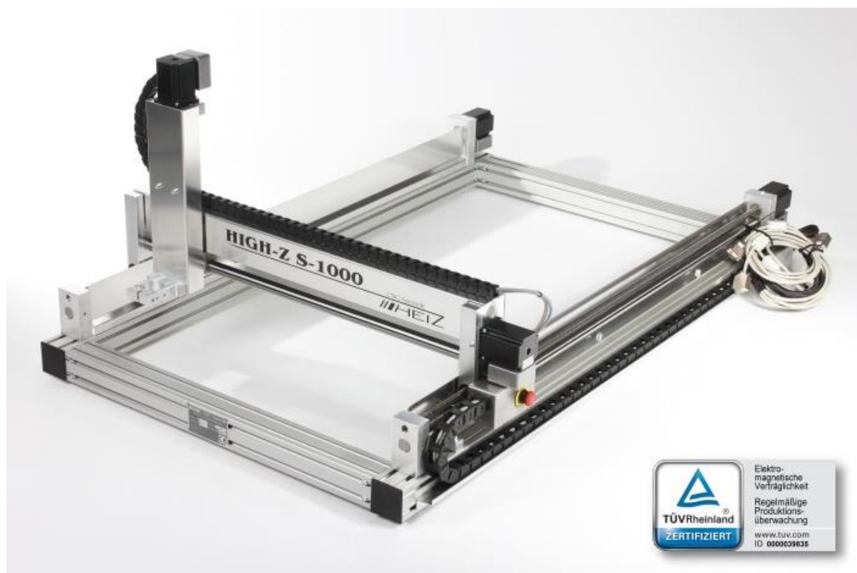
Joonis 2. Tööpink HIGH-Z S-1000 CNC ROUTER [5]
