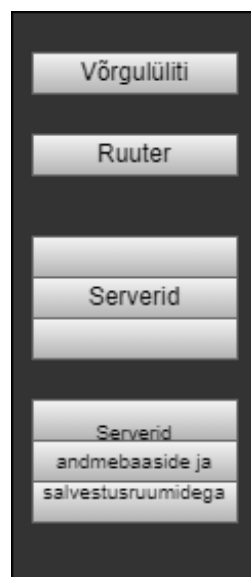
Joonis 2.11 Serverite ühendusskeem seadmepüstikul
