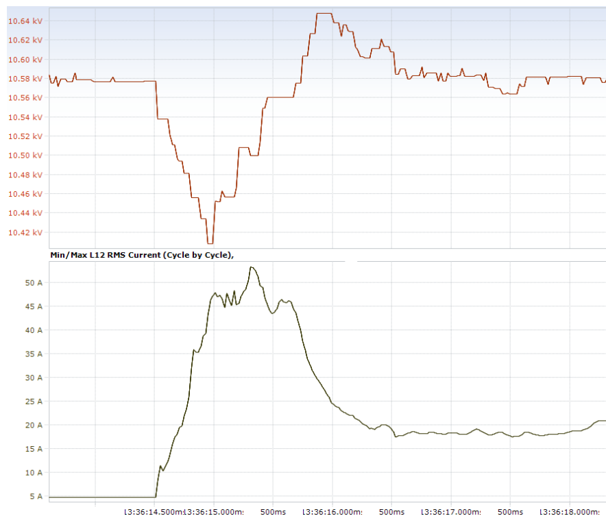
Joonis 6.5. Näide voolu ja pingete efektiivväärtustest elektrijaama nr. 4 tootmiseseadme võrku lülitamisel
