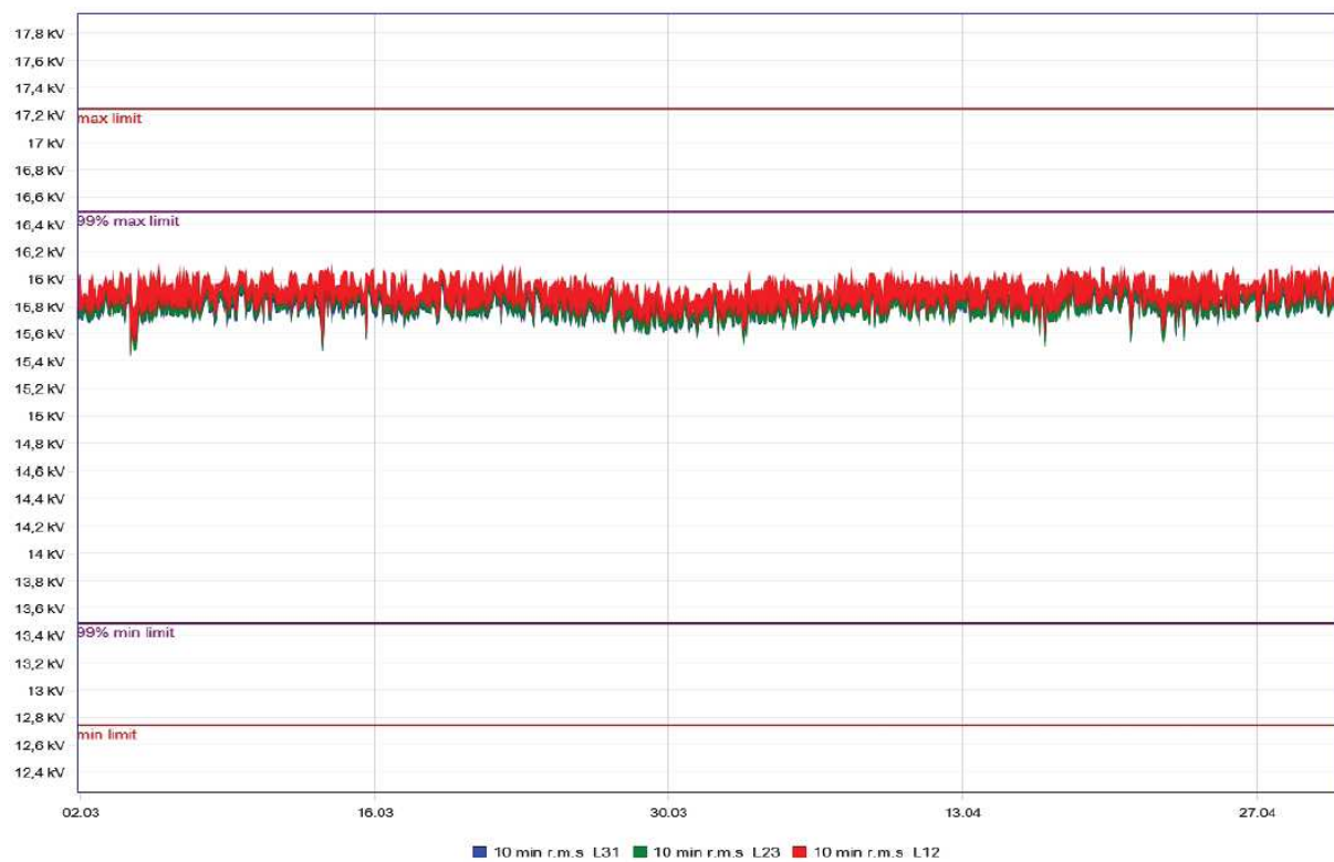
Joonis 6.1. Liinipingete monitoring elektrijaama nr. 1 liitumispunktis
