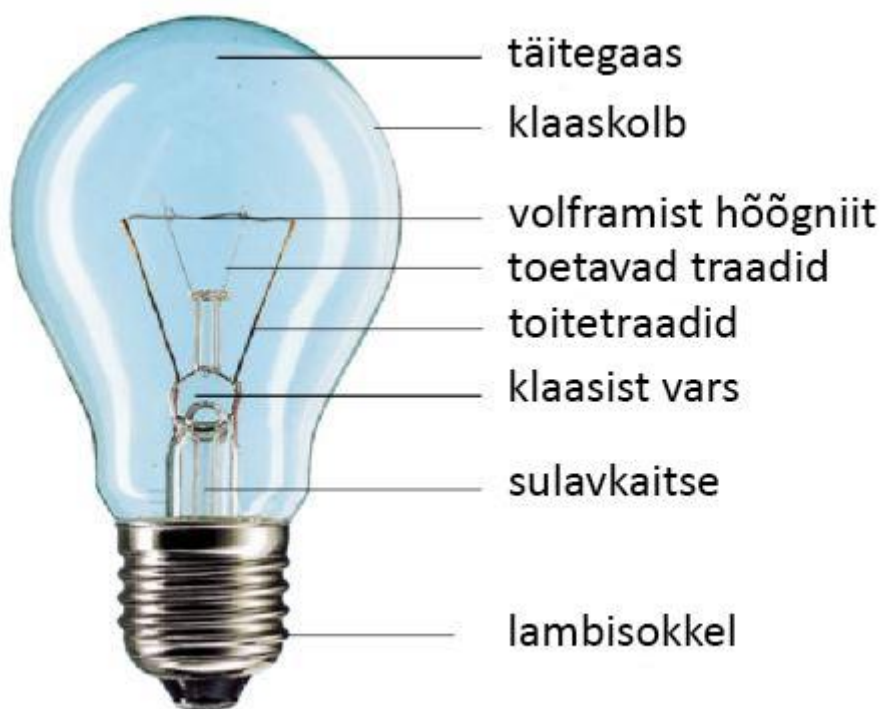
Joonis 4.2 Hõõglambi põhikomponendid [11]
