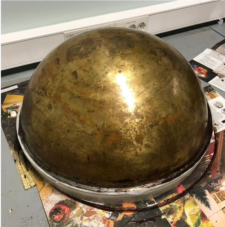
Joonis 2.6 Värv eemaldatud kera välispinnalt
