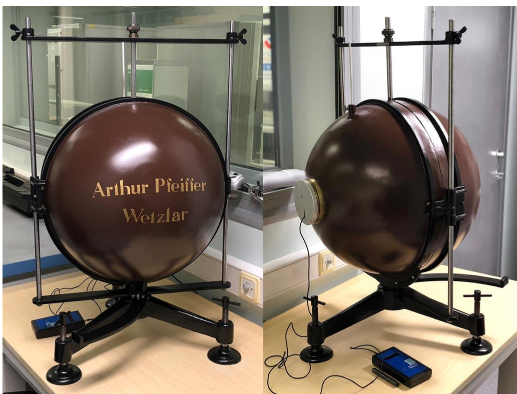
Joonis 2.7 Sfääri välisilme pärast taastamist esiküljelt ja koos valgustiheduse mõõteadapteriga tagaküljelt.
