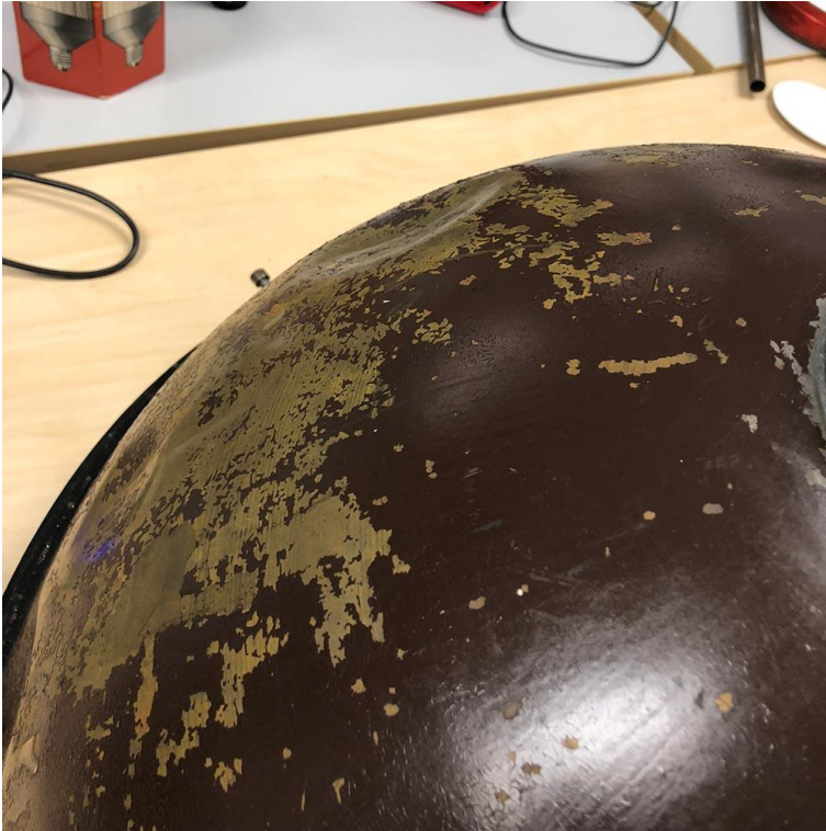
Joonis 2.4 Sfääri kuju deformatsioon
