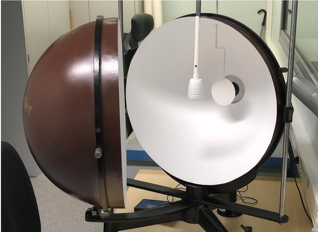
Joonis 2.8 Taastatud sfääri sisepind, varjuk ja konsoolil E27 soklikinnitus pärast taastamist.
