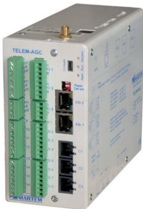
Joonis 4.1 Telem-AGC kahe IO lisamooduliga.[9]
