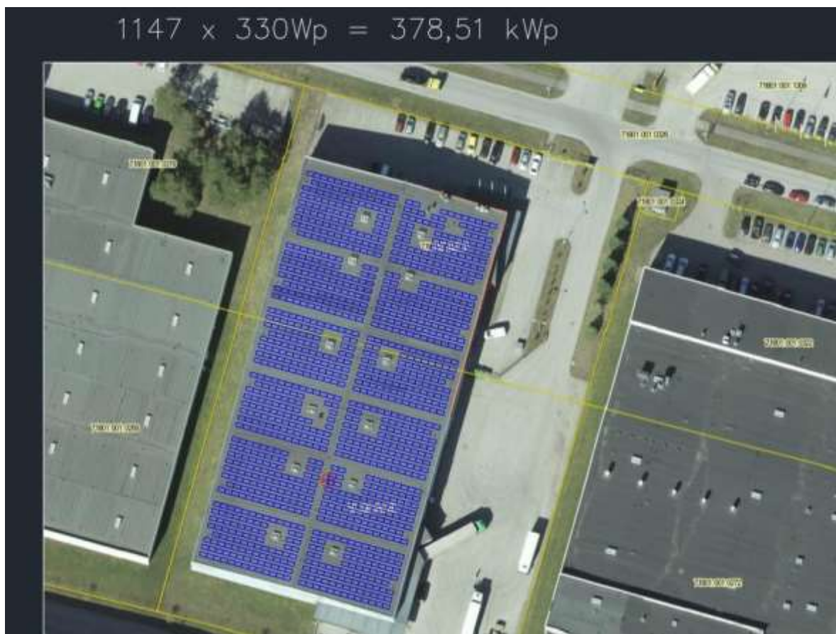
Joonis 4.5 1147 päikesepaneeli Stora Enso tootmishoone katusel
