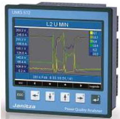
Joonis 3.19. Lokaalne kilbi analüsaator UMG512 [13]
