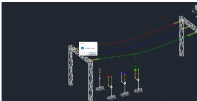
Joonis 4.2 330kV vooltrafode gabariidi kontrolli tulem
