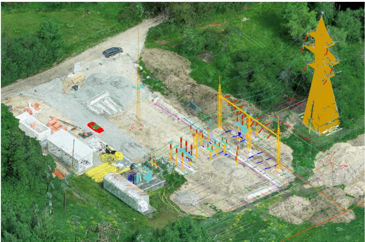
Joonis 6.3 Kaiu 35(110) 10 kV alajaama punktipilv koos mudelprojektiga
