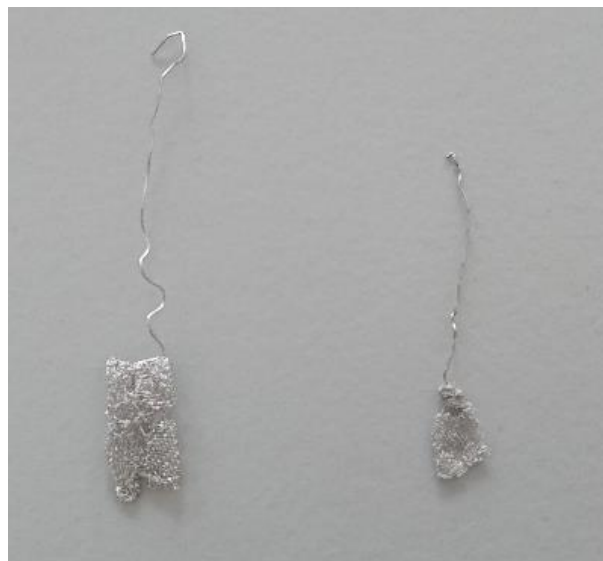
Joonis 3.5 Erineva suurusega Pt-elektroodid
