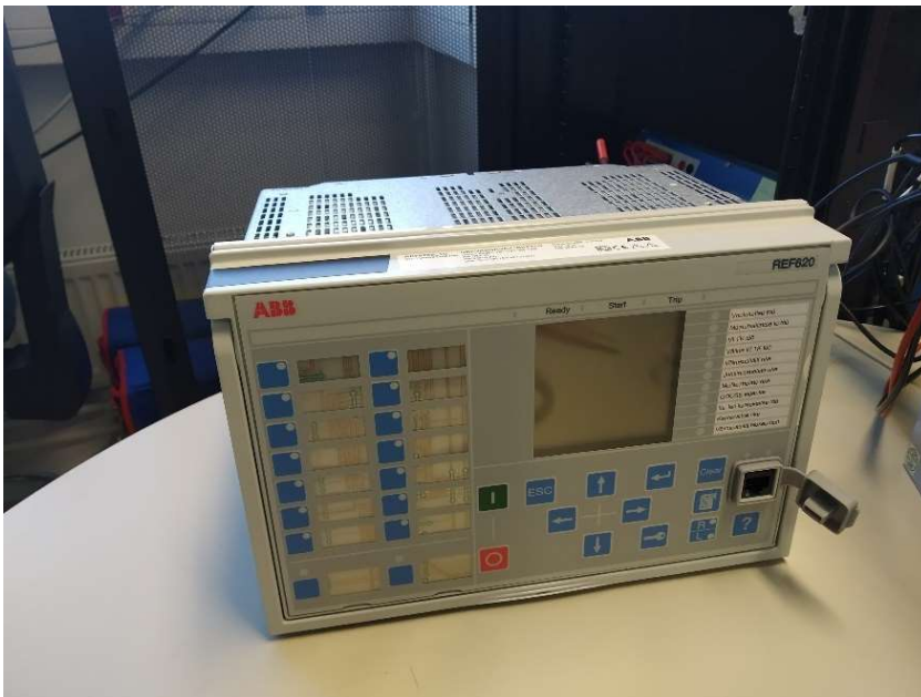
Joonis 3.10 Katsealune ABB REF 620
