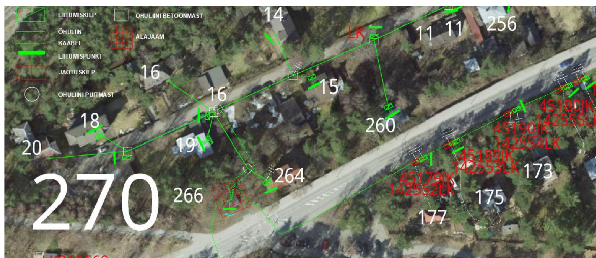
Joonis 1.4 Tarbijate ühendus madalpinge elektrivõrguga läbi alajaama 270:(Nõmme) [9]
