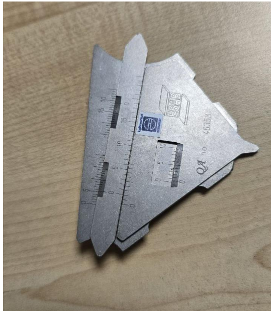
Joonis 16. Kalibreeritud keevisõmbuse mõõdik
