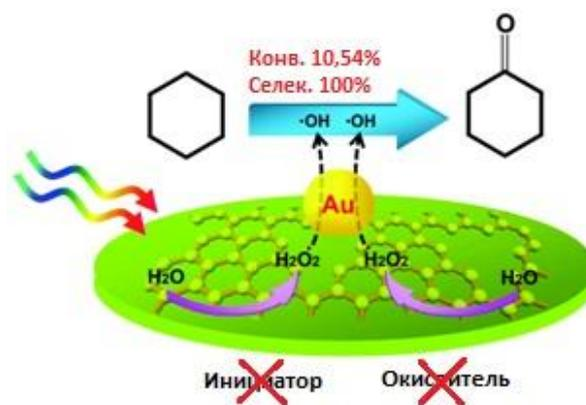
Рисунок 2.5. Механизм реакции окисления циклогексана на поверхности  $C_3N_4$  / Au под действием видимого света [35]
