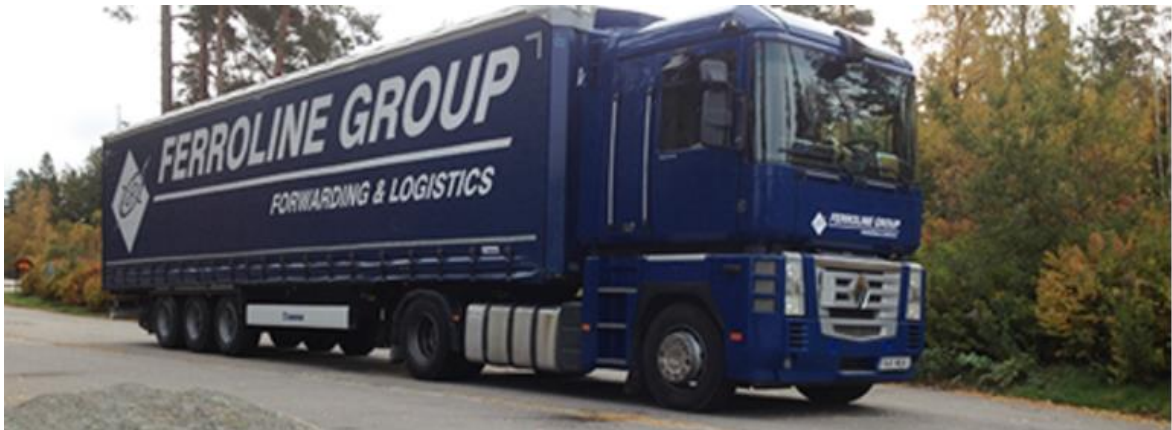
Joonis 3. Ferroline'i 2-teljelisest veoautost ning 3-teljelisest haagisest koosnev autorong Allikas: (Ferroline Grupp OÜ kodulehekülg)
