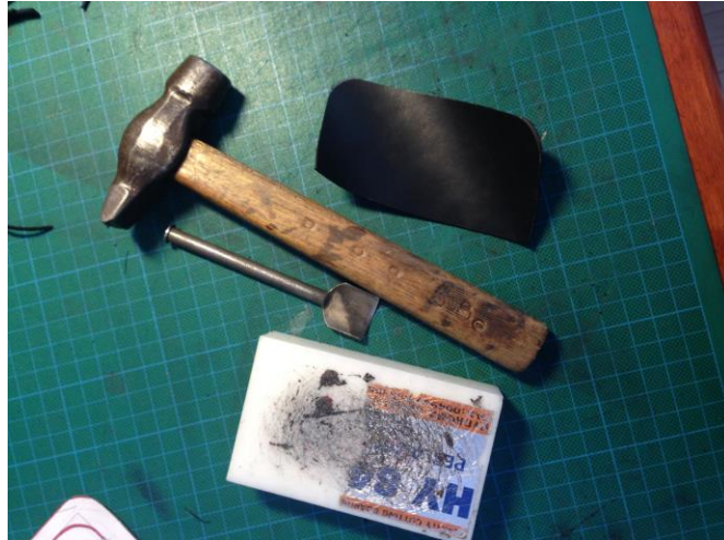
Foto 17. Polüvinüülkloriidist lõikelaud, kumerate nurkade vormimise abivahend
