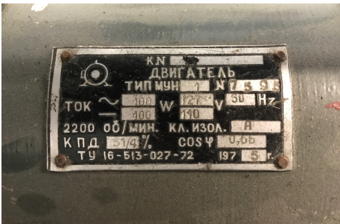
Sele 3.2 Elektrimootori andmeplaat. Autori foto
