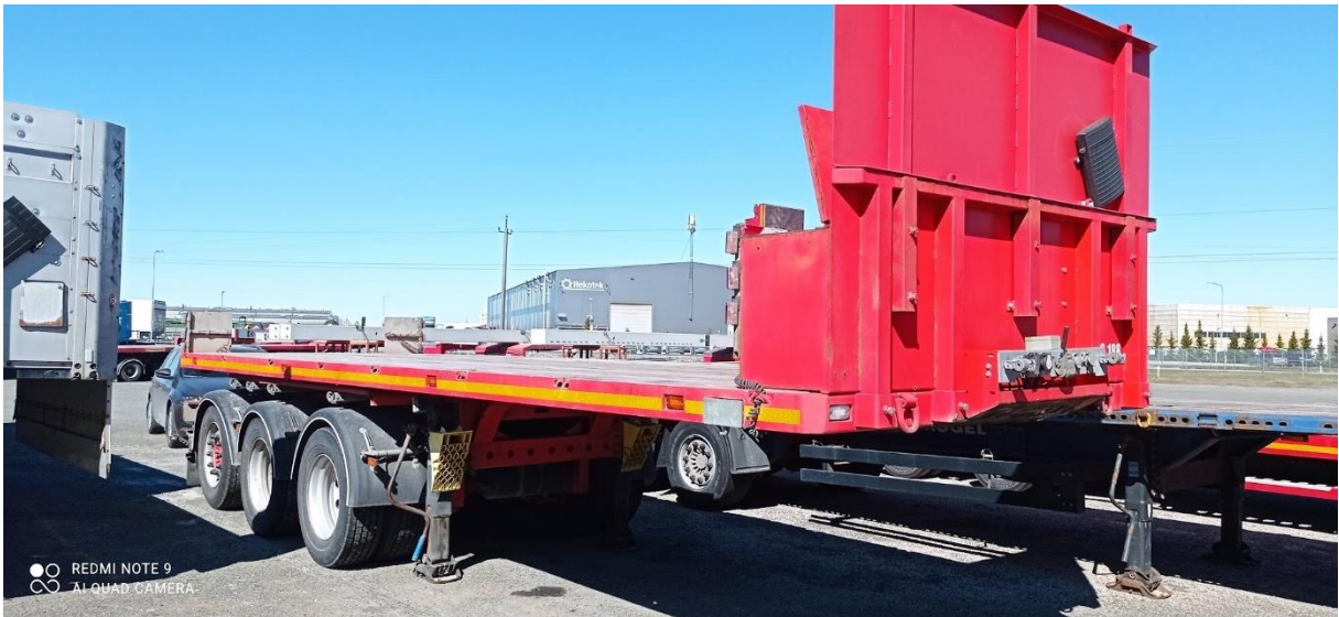
Joonis L47. B-link poolhaagis eestvaade
