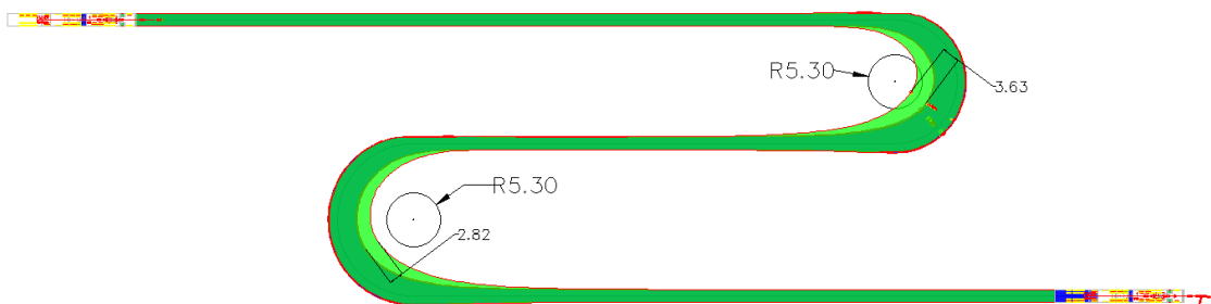
Joonis L60. EMS 3 sõiduki kõrvalekalde liikumiskoridorist, mõõtmed meetrites
