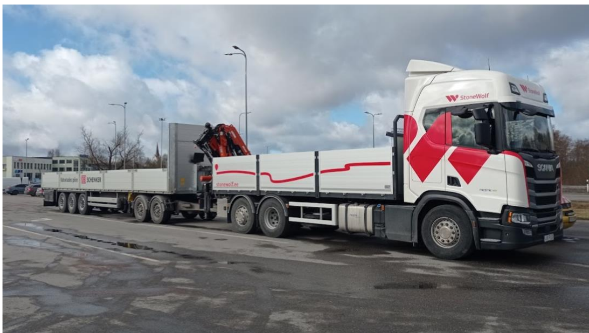
Joonis L43. Sadulveok 6x4 veoskeemiga
