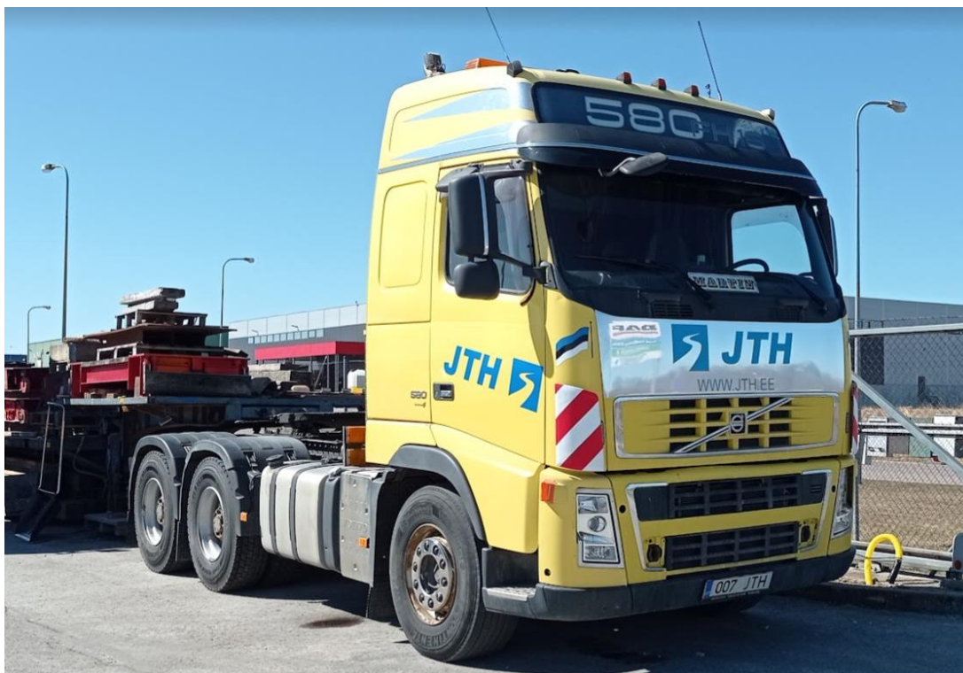
Joonis L43. Sadulveok 6x4 veoskeemiga
