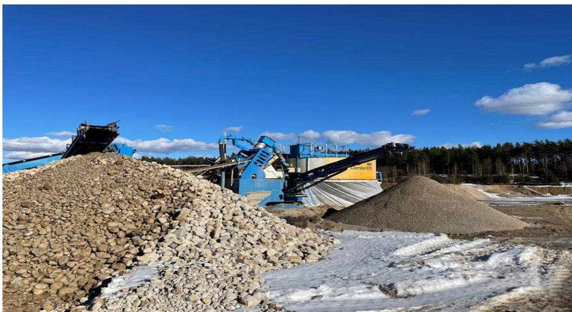
Joonis 6. Tootmine talvel. Pestud kivi fr.30 -100mm ja pestud liiv fr. 0-30mm. (Randjärv, 2019)
