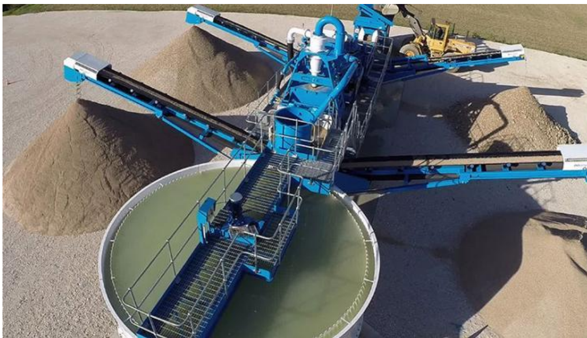
Joonis 3. Settevanniga ja eelpesuseadmega pesukompleks. CDE
