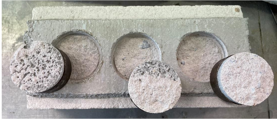
Joonis 2.22 Nakketugevuse katsekeha purunemispildid [autori erakogu]
