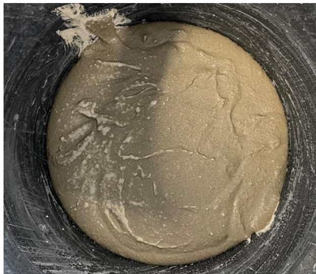
Joonis 3.16 Maksimaalse koguse veehoidvuslisandiga mördisegu peale 1 h seismist [autori erakogu]
