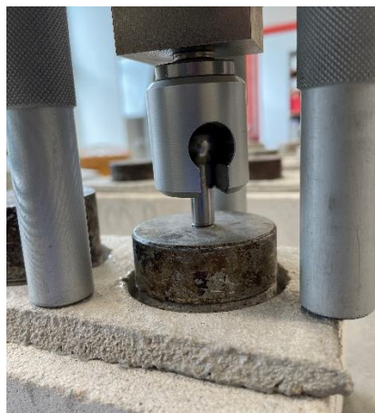
Joonis 2.21 Nakkeseadme fikseerimine tõmbeplaadiga [autori erakogu]
