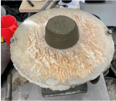
Joonis 2.13 Mõrt raputuslaual peale tükivõõrunuse eemaldamist [autori erakogu]
