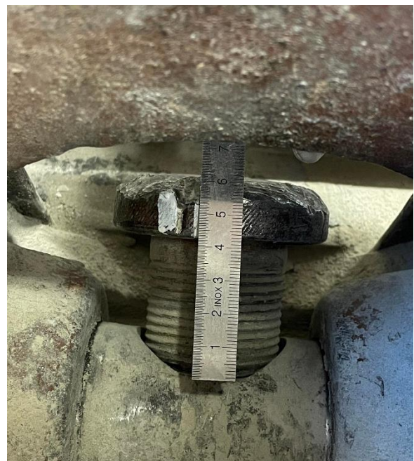
Joonis 2.5 Lõugpurusti lõuavahe fikseerimine [autori erakogu]
