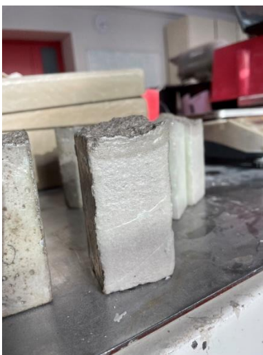
Joonis 2.14 Parafiiniga kaetud katsekeha [autori erakogu]
