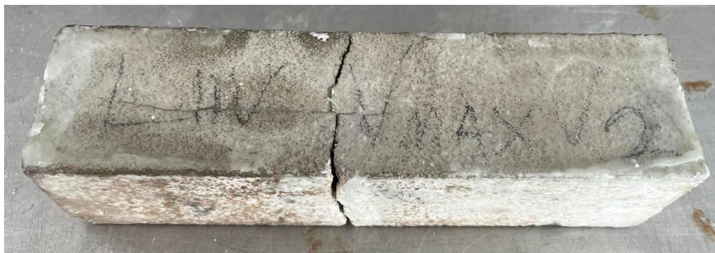
Joonis 3.22 0% PSKL-iga ning V 0,7 % MAX lisandiga tehtud katsekeha mahukahanemine [autori erakogu]
