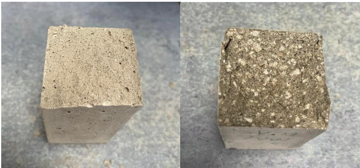
Joonis 3.25 100 % PSKL-i sisaldusega ning MIN V lisandiga tehtud katsekeha [autori erakogu]
