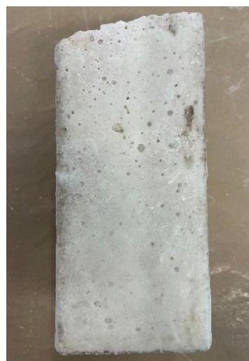
Joonis 2.15 Parafiini täis muljutud katsekeha poorid [autori erakogu]
