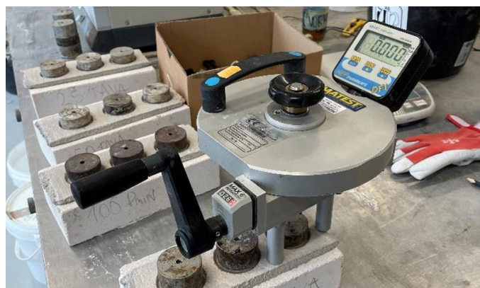
Joonis 2.19 Nakketugevuse katseseade Matest Mod, E142 [autori erakogu]
