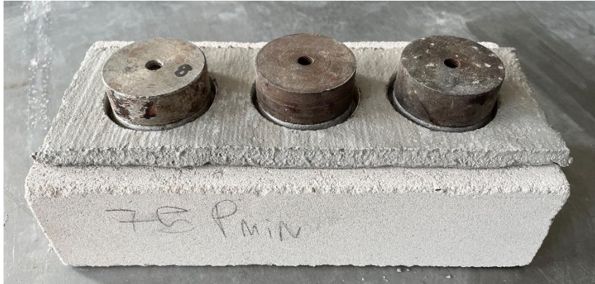
Joonis 2.20 Tõmbeplaatide asetus nakketugevuse katsekehal [autori erakogu]
