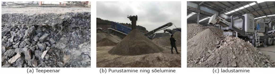
Joonis 1.14 Uuringus kasutatud täitematerjali tootmisprotsess [11]
