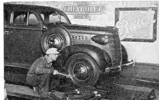
Üks pilk piduri reguleerimise ajal katsepingi automaatsetele osutitele näitab, kas ratta pidur on õieti reguleeritud
