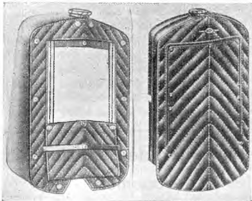
Radiaatori kate. Vasakul — avatud; paremal — suletud
