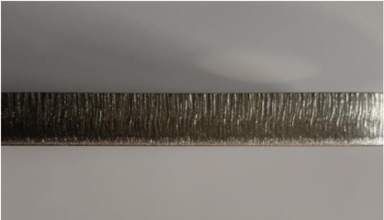
Joonis 16. Happekindla AISI316 10,0 mm katsekeha lõikeserv laserlõikuse korral
