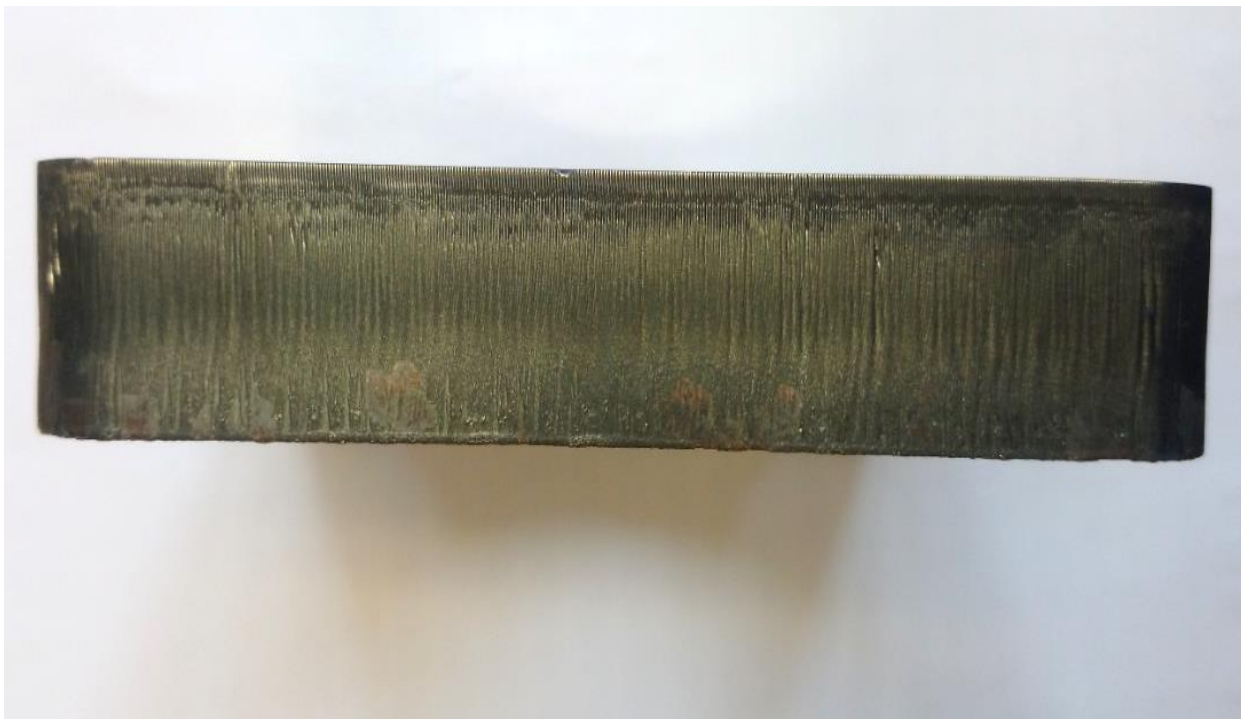
Joonis 21. Laserlõigatud S355MC 10,0 mm katsekeha
