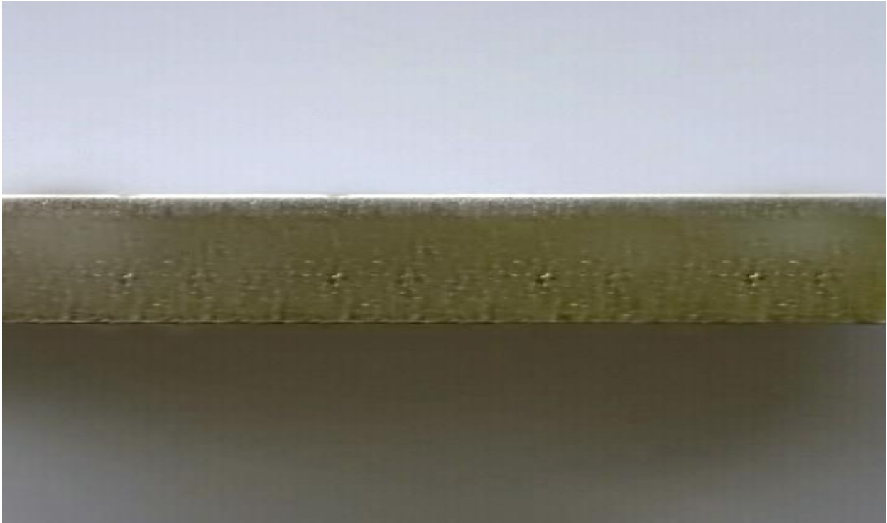
Joonis 22. Vesi-abrasiiv lõigatud S355MC 10,0 mm katsekeha
