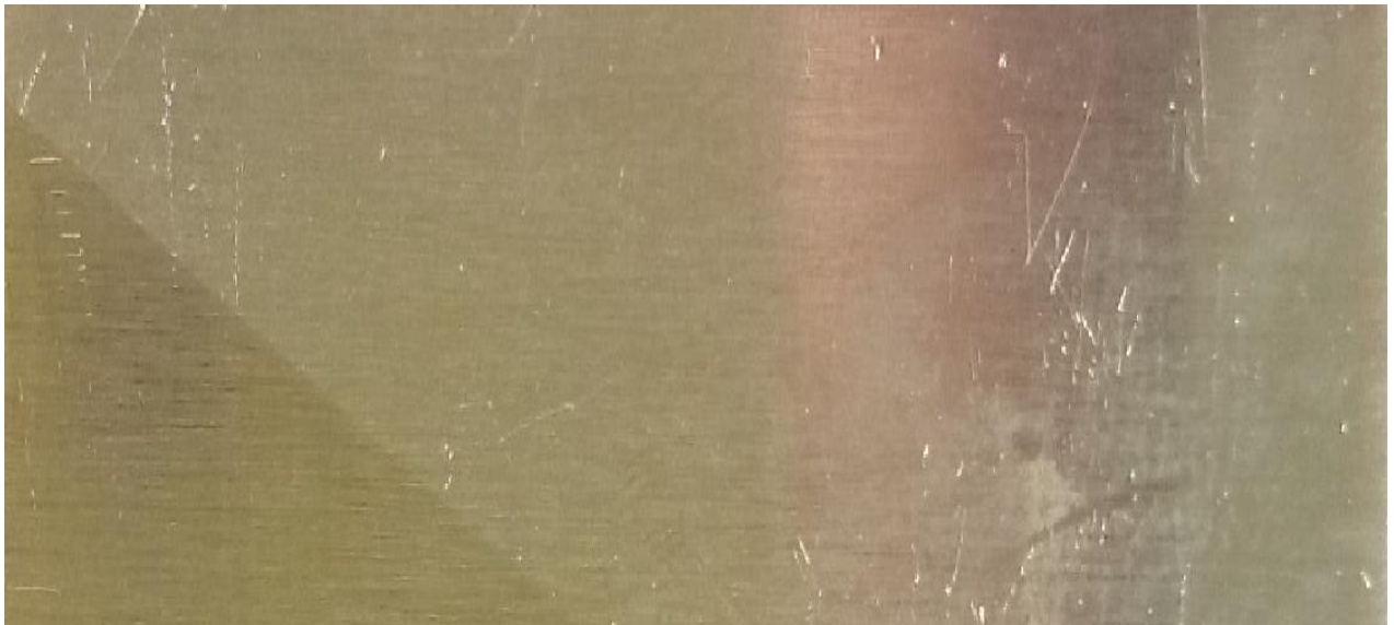
Joonis 20. Vesi – abrasiiv tehnoloogiaga AISI316 3,0 mm katsekeha lõikeserv
