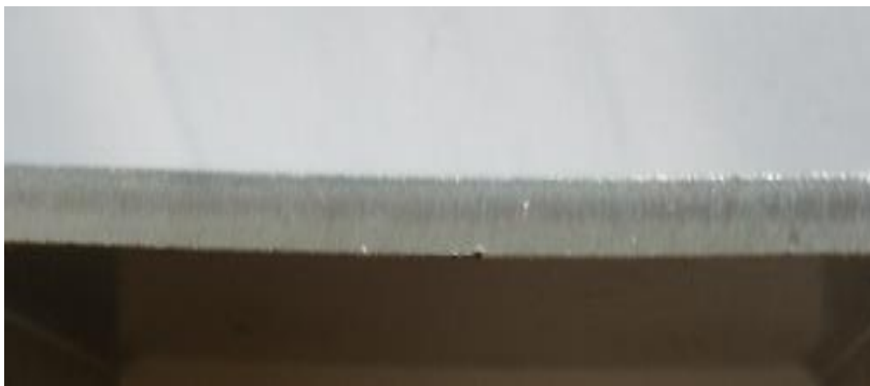
Joonis 19. Stantsitud AISI316 3,0 mm katsekeha lõikeserv
