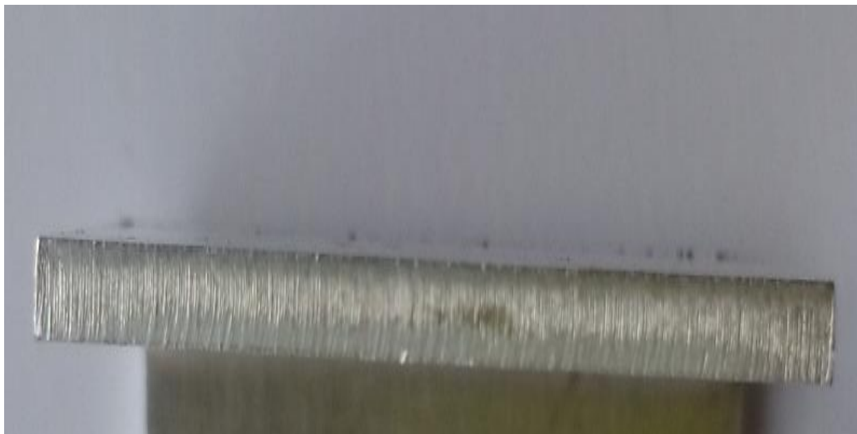
Joonis 18. Laserlõigatud AISI316 3,0mm katsekeha lõikeserv
