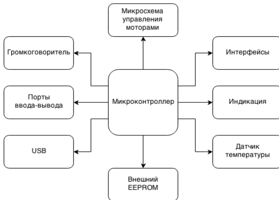
Рисунок 1. Общая блок-схема макетной платы.
