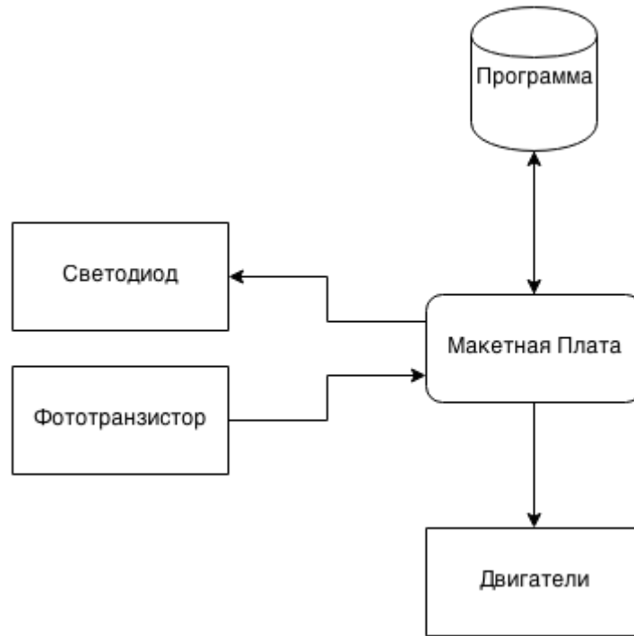
Рисунок 18. Блок-схема примитивного робота.
