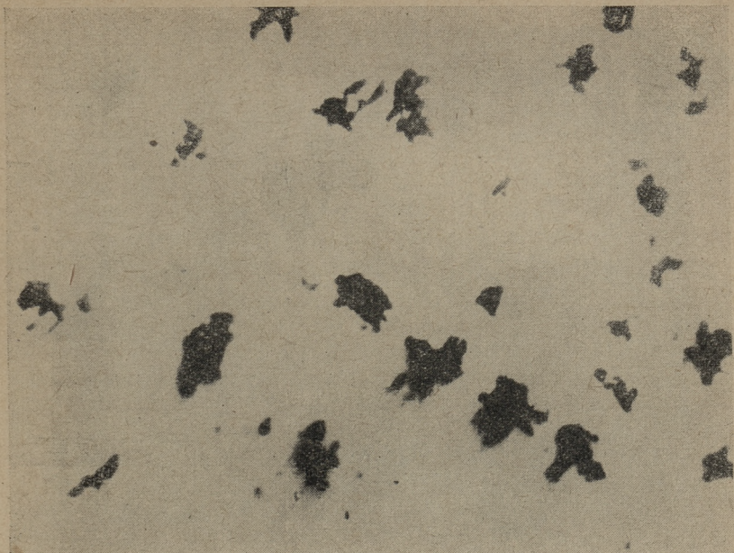
Фиг. 6. Микроструктура чугуна (плавка Б; отжиг при 970^{\circ}\text{C} ; шлиф не травлен) \times 200
