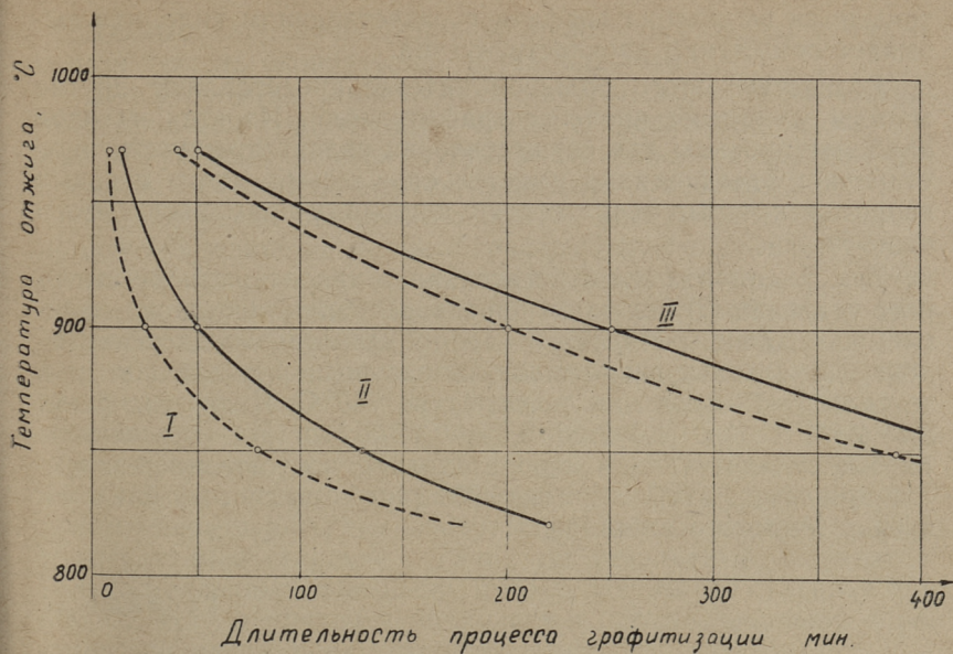
Фиг. 6. Изотермическая диаграмма распада цементита (плавка Б). Сплошные кривые на графике относятся к чугуно без старения, пунктирные кривые — со старением при температуре 325°С:
