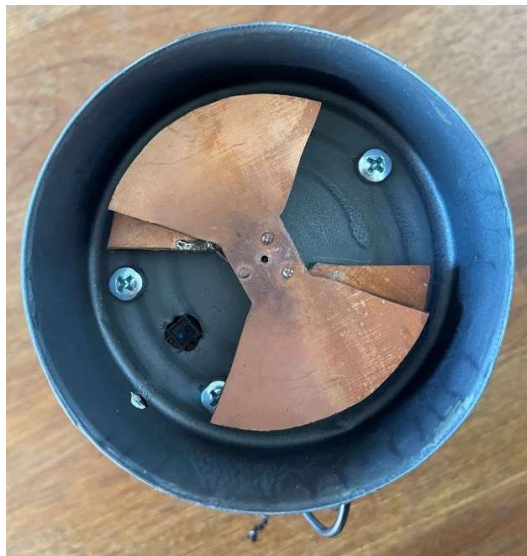
Joonis 8. Field mill mõõteseadme anduriosa põhikomponendid: andurplaadid, propeller ja optopaar.
