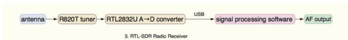
Joonis 1. Töös kasutatud SDR-i plokk-skeem.
