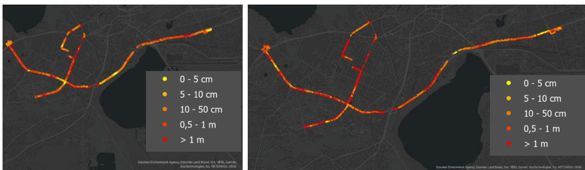
Joonis 5.23. 12.03.2022 mõõtmistulemuste horisontaalsed vead (vasakul) ja vertikaalsed vead (paremal)
