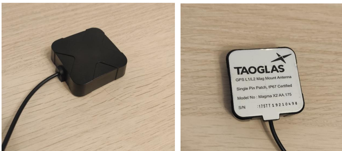
Joonis 3.3. Taoglas MAGMA X2 GNSS antenn
