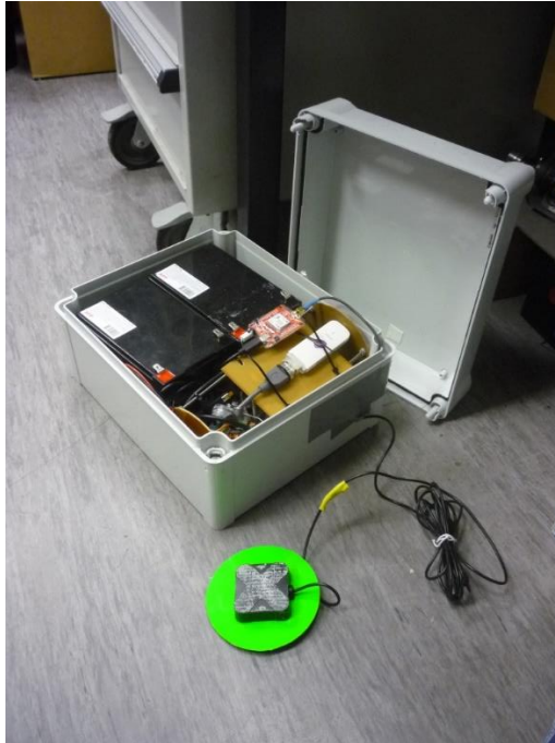
Joonis 4.7 Mereveetaseme mõõtmistel kasutatud mõõtesensor (Foto Jaan Rebane)
