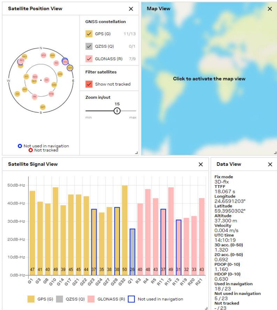
Joonis L3.1. Kuvatõmmis u-center 2 ühe päeva satelliitide nähtavusgraafikust (mõõtmised Ehituse Mäemaja katusel)
