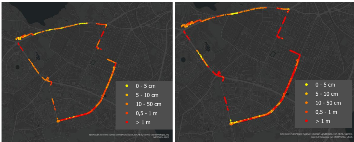
Joonis 5.22. 08.03.2022 mõõtmistulemuste horisontaalsed vead (vasakul) ja vertikaalsed vead (paremal)
