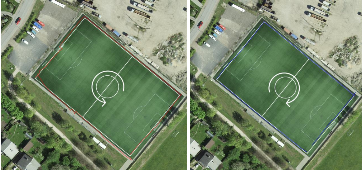
Joonis 5.18. Kuressaare jalgpalliväljaku täisväljaku mõõtmiste trajektoori (20.03.2022) esimene (vasakul) ja teine käik (paremal)
