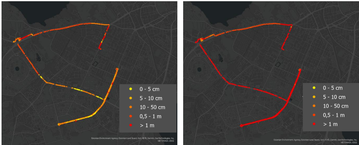
Joonis 5.21. 16.12.2021 mõõtmistulemuste horisontaalsed vead (vasakul) ja vertikaalsed vead (paremal)
