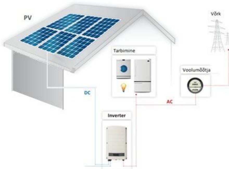
Joonis 4.1. Tavaline fikseeritud PV-süsteem [29]
