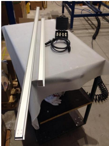
Joonis 2.4. PV-paneelide raamide detailid ja ühenduskarp
