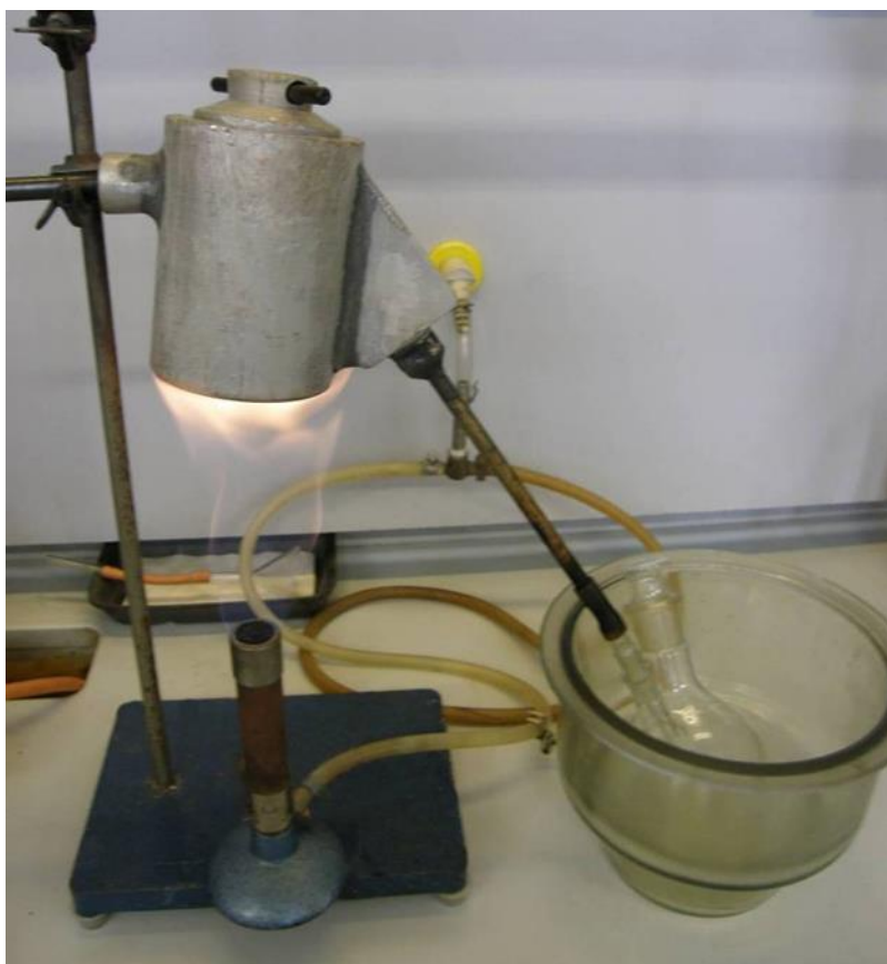
Joonis 1.4 Õli saamine Fisheri retordis
