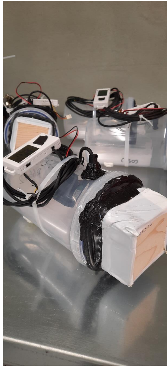
Foto 2.3 Freesitud topsiaugud soojustusplaadis (vasakul) ja ukse sisse paigutatavad katsetopsid (paremal)
