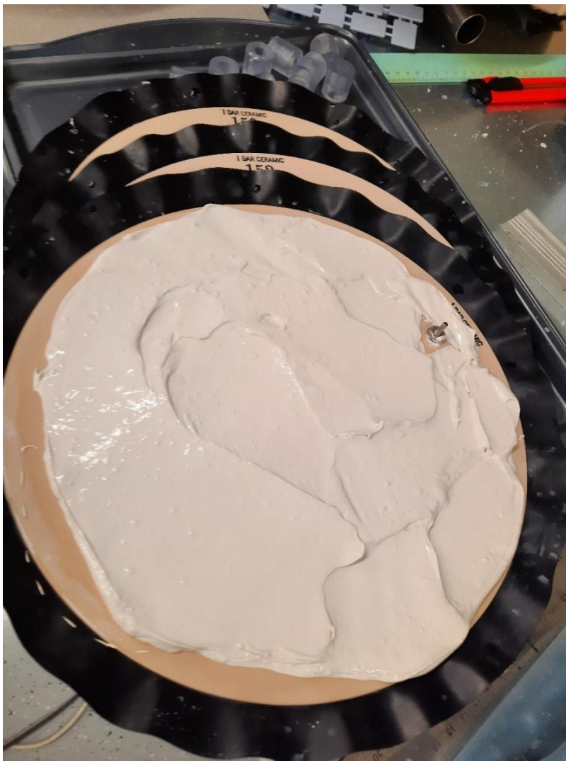
Foto 2.14 Savialuse valmistamine rõhuplaadile
