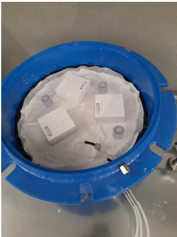
Foto 2.17 Kaltsiumsilikaadi katsekehad filterpaberist eralduskihil
