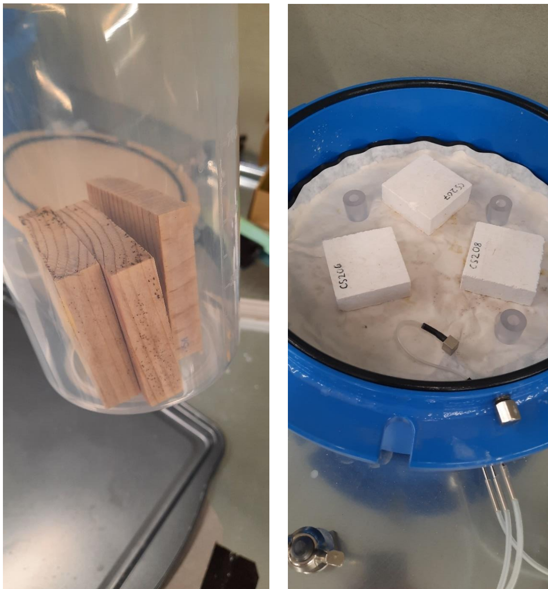
Foto 2.18 Hallitavad puitkatsekehad (vasakul) ja hallitav filterpaber (paremal).
