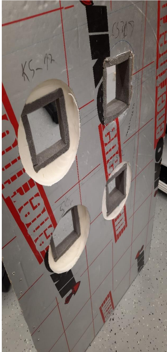
Foto 2.3 Freesitud topsiaugud soojustusplaadis (vasakul) ja ukse sisse paigutatavad katsetopsid (paremal)
