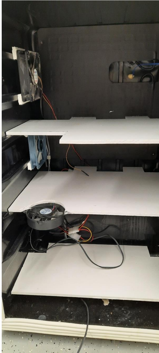
Foto 2.4 Külmikusse ehitatud ventilatsioonisüsteem ja sahtlid
