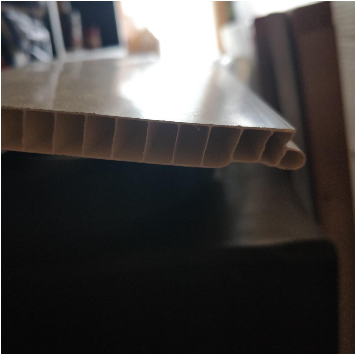
Joonis L2.1 PVC fassaadikattematerjali läbilõige.
