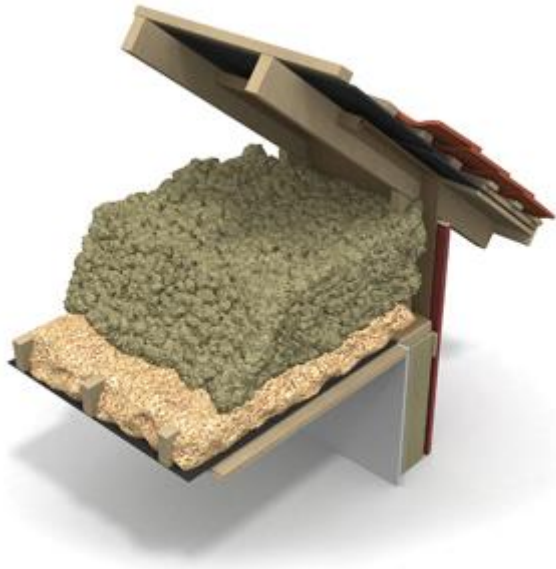
Joonis 7.2. Kütmata pööningu soojustamine puistevillaga. [24]
