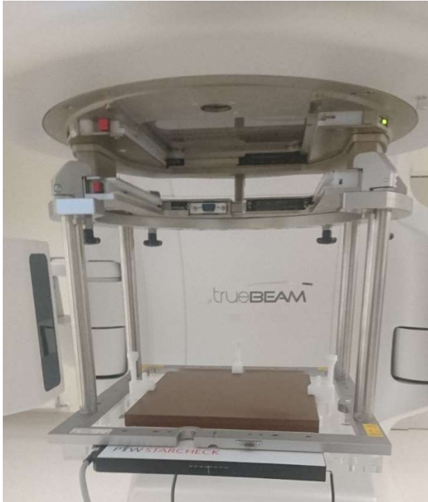
Joonis 9. Katseskeem. StarCheck T10043 (PTW) dosimeeter on kinnitatud SC Holding Device T41021.1.030 (PTW) peale, mis omakorda on kinnitatud lineaarkiirendi (antud joonisel Varian TrueBeam®) kanduri külge. Kaks fantoomi (pruuni värvi plaadid) on paigaldatud kiirgusdetektori peale.
