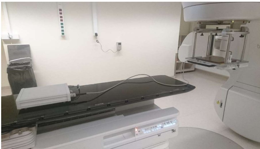
Joonis 10. Täielok katseskeemi konstruktsiooni pilt. Joonise paremal poolele on näidatud katseskeemi konstruktsioon ja vasakul poolel on näidatud patsiendilaud ja dosimeeter Detector Interface 4000 (PTW).
