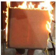
a) Test 9a – Plaster system ClaySU04
