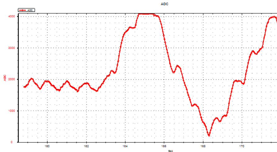
Joonis 2.5 Käesolevas töös valminud radari väljundsignaal [mV].
