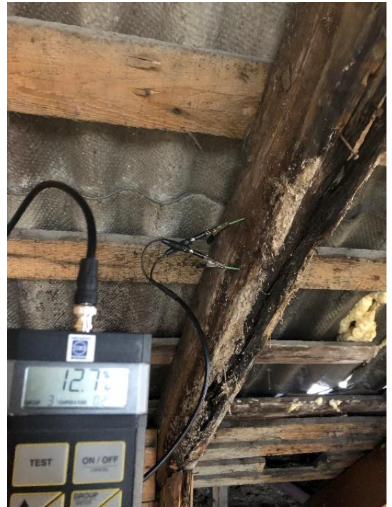
Joonis 27 Niiskumõõdistus. Mädanenud sarikas. Autori erakogu
