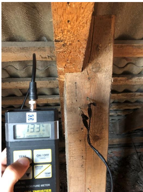
Joonis 29 Niiskumõõdistus. Pärlin post. Autori erakogu
