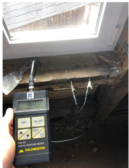
Joonis 28 Niiskumõõdistus. Veekahjustusega aknalaud. Autori erakogu
