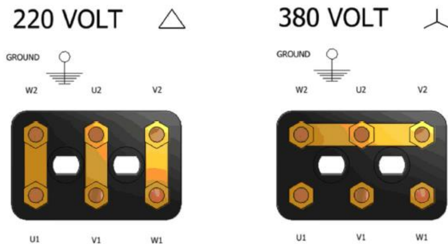
Sele 4.1 Elektrilise spindli ühendusskeemid [7]
