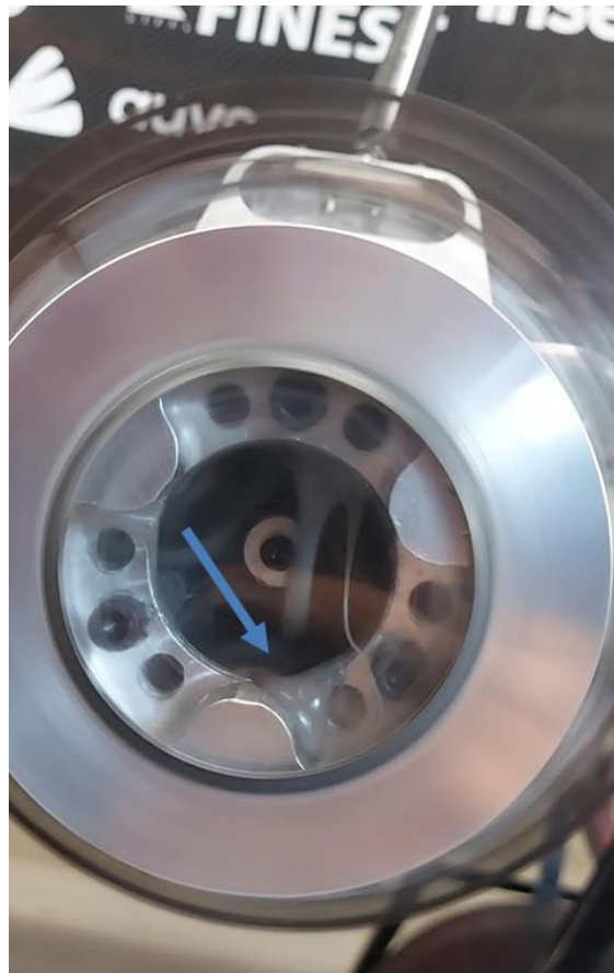
Joonis 6.2 Õli jaotumine pöördel 11000
