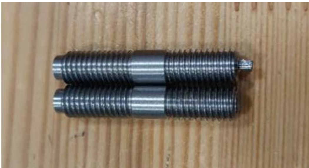
Joonis 5.27 Tikkpolt peale töötlust
