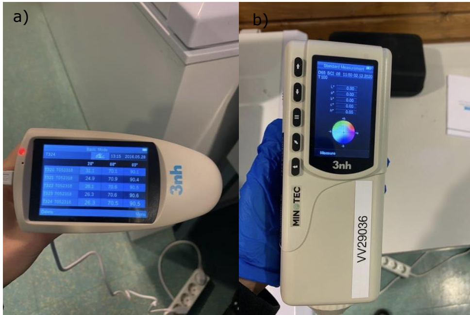
Joonis 2.6.3.1 a) läike mõõtja (3NH HG268) ; b) värvuse mõõtjad (3NH NR60CP)
