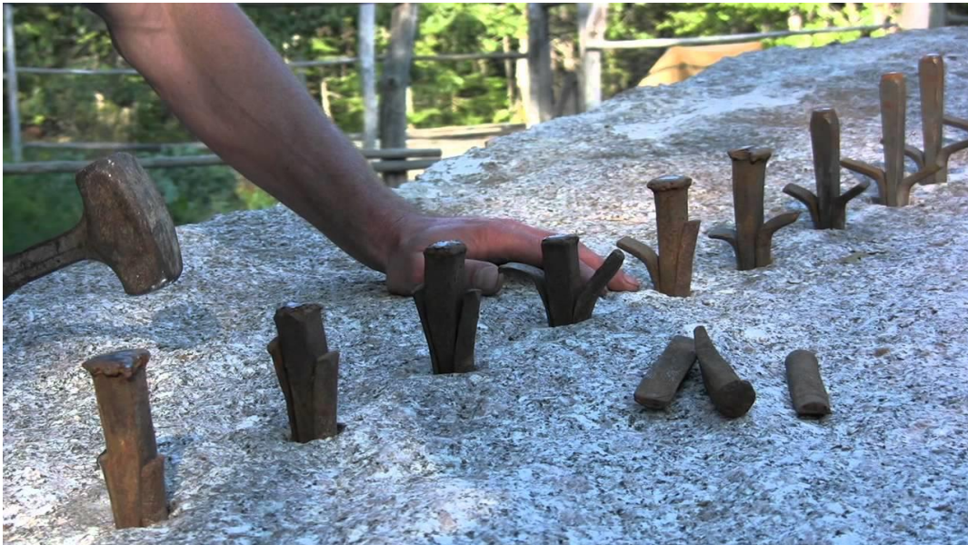
Joonis 11: Näide käsitsi kiiludega murdmisest (Nõmmela & Rudanovski, 2012).
