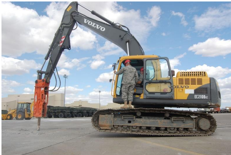
Joonis 20: Kihiti murdmiseks hüdrovasar (Autor: T. Tomberg, 2020)
