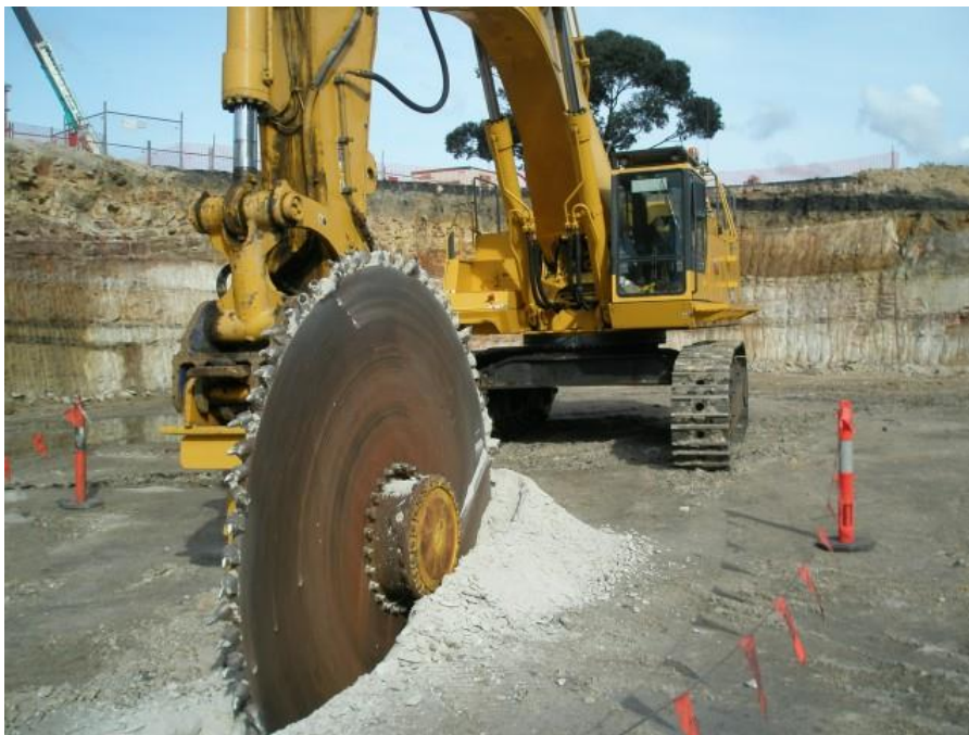
Joonis 10: Ketassaaga kivimi saagimine karjääris (Autor: E. Tomberg, 1999).
