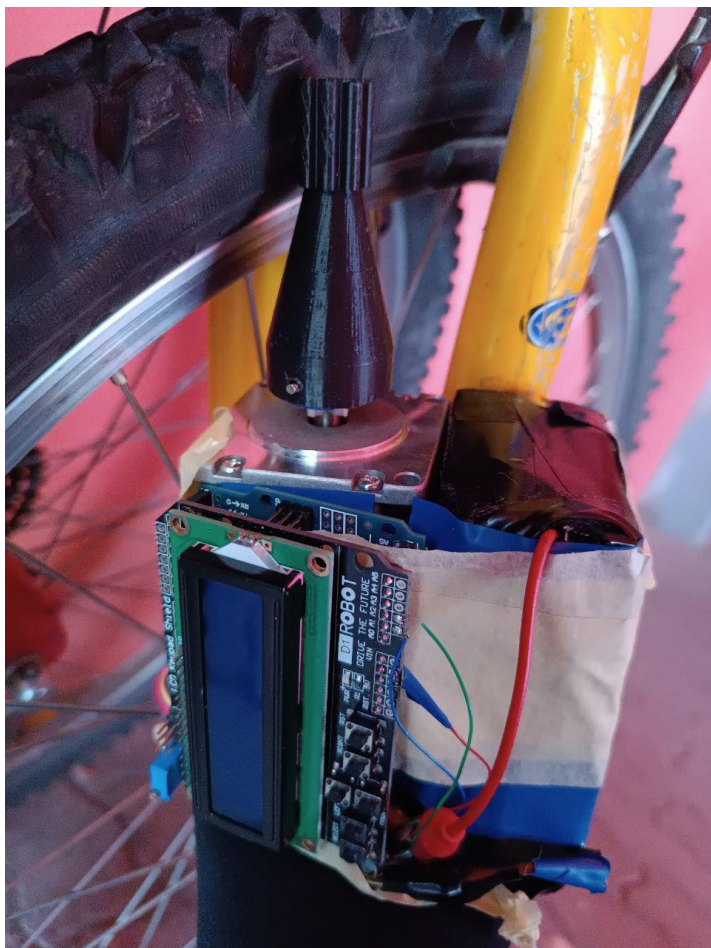
Joonis 2.1.2. Elektriallika prototüüp jalgratta küljes.
