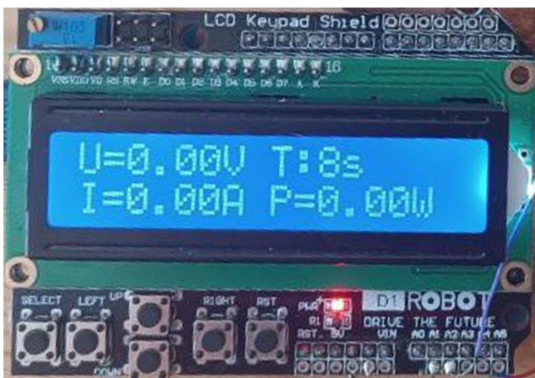
Joonis 5.0.1. LCD ekraan Arduino plaadil.
