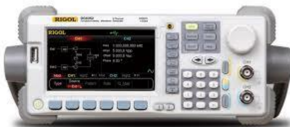
Joonis 25. Programmeeritav lainekuju/funktsioonigeneraator Rigol DG5252
