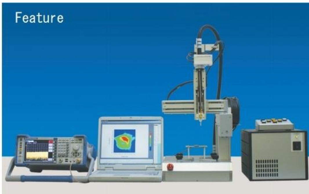
Joonis 2. Jaapani ettevõtte PERITEC seade EMI Tester EMV-100
