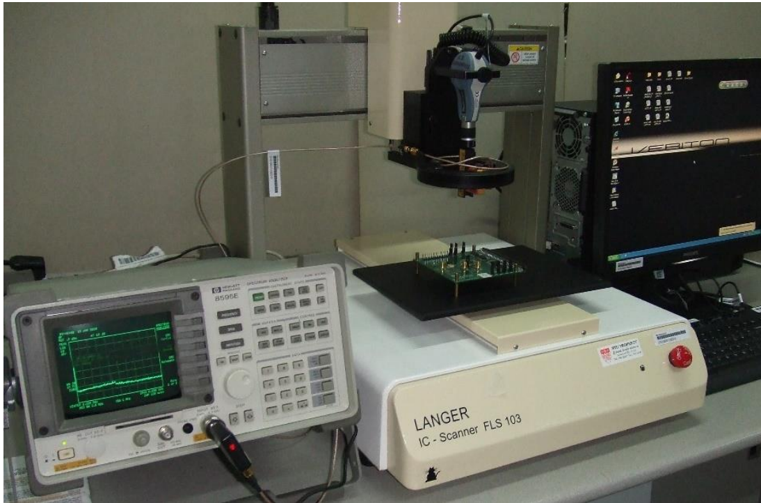
Joonis 3. Nanyang Technological University loodud mõõteseadade Langer IC Scanner Fs 103
