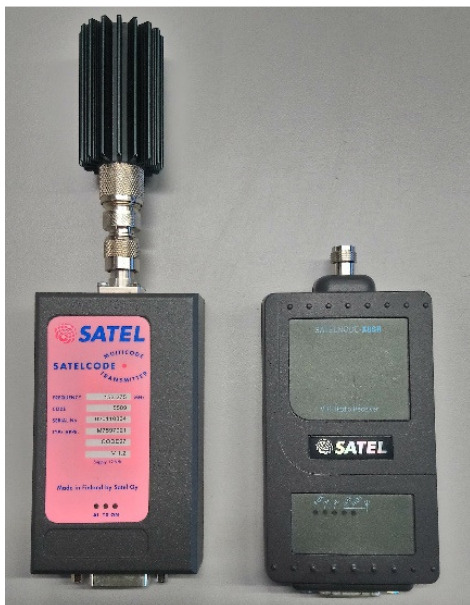
Joonis 22. SATELCODE saatja ja SATELNODE vastuvõtja
