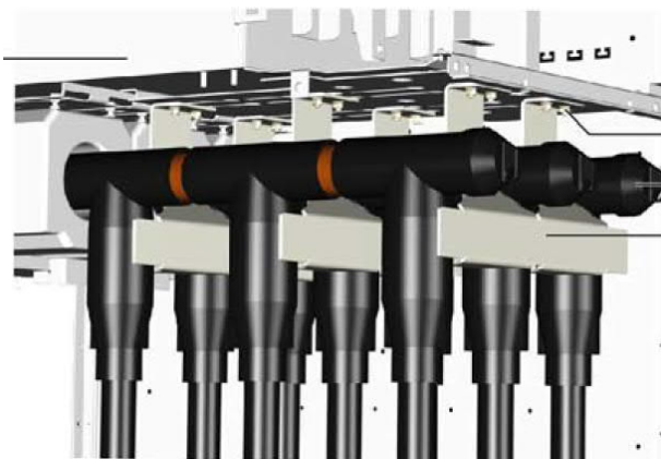
Joonis 1.5 Kaabliühendused jaotusseadme NXPlusC kaabliruumis [4]
